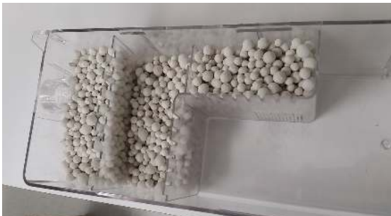
Figure 1 – Verser le média Liphter + uniformément dans les 3 premières cellules du NT1-P
